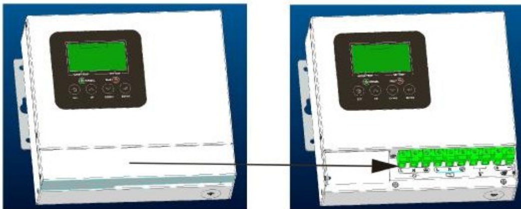
Obrázok: (Ilustrácia znázorňujúca správny postup odstránenia krytu kabeláže)
